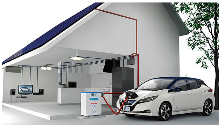
Rys. 19 Za pomocą systemu Vehicle-to-Grid energię elektryczną można pobierać i oddawać do sieci albo układu domowego
