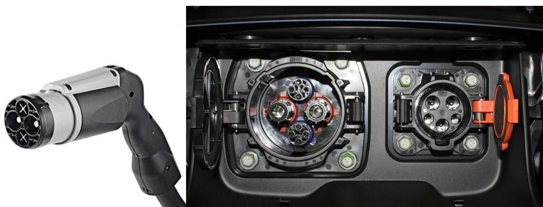
Rys. 15 Gniazda ładowania AC i DC w samochodzie Nissan LEAF, po lewej wtyczka i gniazdo CHAdemo dla DC i po prawej TYPE1 dla AC
