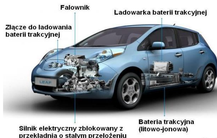
Rys. 28 Podstawowe elementy samochodu elektrycznego
