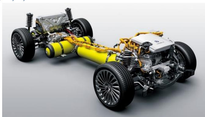
Rys. 9 Schemat działania pojazdu elektrycznego zasilanego ogniwami paliwowymi (FCEV)
